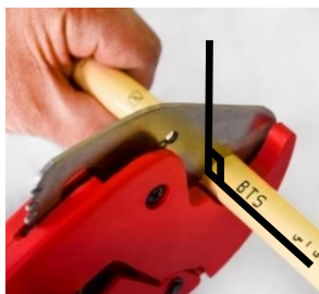
شکل ۳۴-۱ قیچی لوله بر مخصوص لوله پنج لایه
