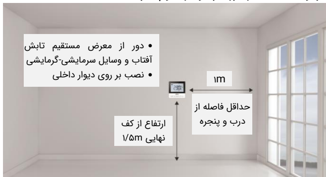
شکل ۴۱-۲ محل نصب ترموستات اتاقی
