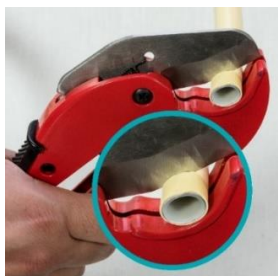
شکل ۳۵-۱ دو پهن شدن لوله در اثر برش غلط
