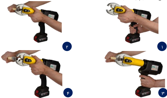
شکل ۶-۱ نحوه پرسی اتصالات به وسیله دستگاه پرسی
